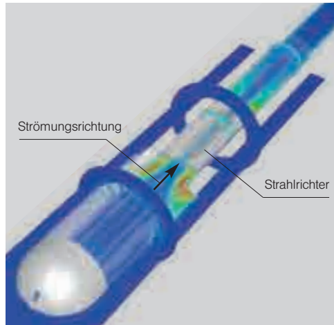
Die Simulation der CFD-Turbulenzen des SCALEMASTER HPS zeigt optimale innere Strömungsverhältnisse ohne Turbulenzen (dunkelblauer Bereich) komplett bis zum Mundstück.
