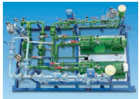
Pumpen- und Regulierstation
