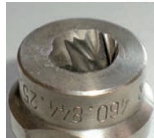
Kép 2: Egy tellikúp fúvóka kopása
