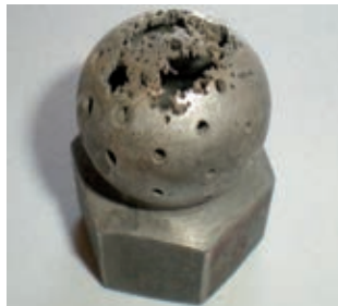
Kép 1: Kémiai korrózió egy fúvókán
