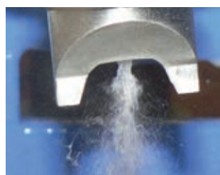
11. ábra: Zselatin porlasztása a Lechler ViscoMist kétanyagos fúvókával
