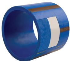
PE Rohre mit additiver Schutzschicht und diffusionsdichter Barrierschicht aus Aluminium werden üblicherweise für die Verlegung in kontaminierten Böden eingesetzt. So wird ein Eindringen von Schadstoffen ins Rohr und das Diffundieren vom Medium ins Erdreich verhindert. STRAUB-PLAST-PRO verbindet solche Mehrschichtrohre einfach und sicher ohne jegliche Rohrendenbearbeitung.
