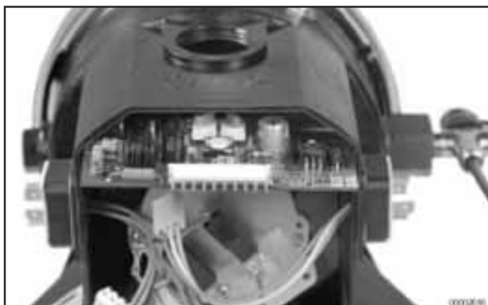
16. ábra: A szivattyúházba szerelt vezérlőpanel
