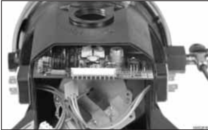
4. ábra: Szivattyúházba épített vezérlőpanel
