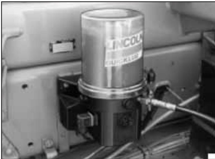
20. ábra: Szivattyú tartályának feltöltése
