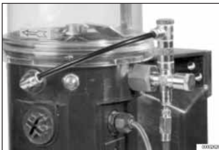
13. ábra: Nyomáshatároló szelep kenőanyag-visszavezetéssel
