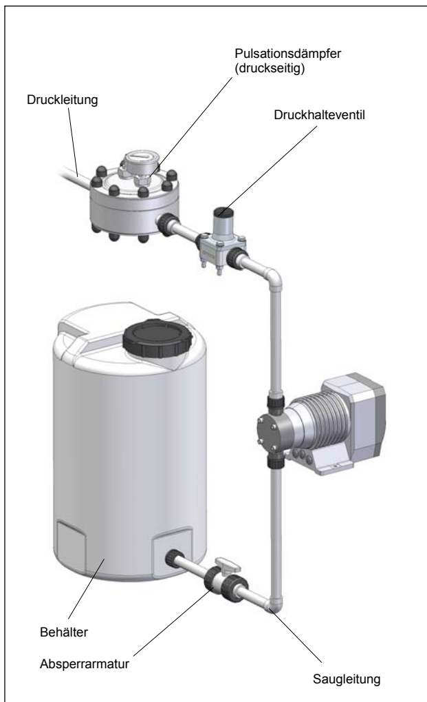
Abb. 30 Installation Pulsationsdämpfer und Druckhalteventil
