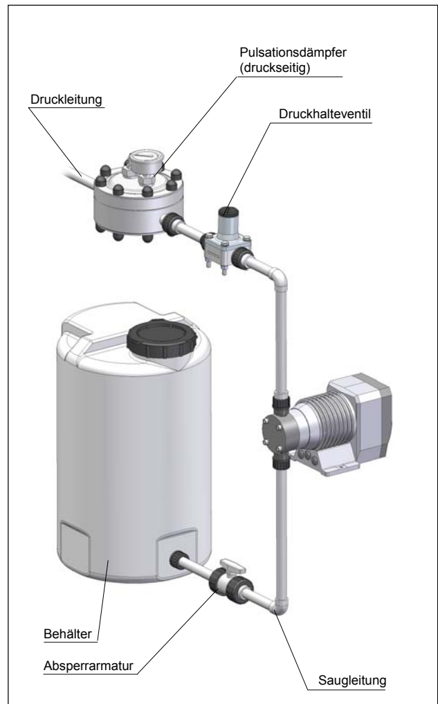
Abb. 28 Installation Pulsationsdämpfer und Druckhalteventil
